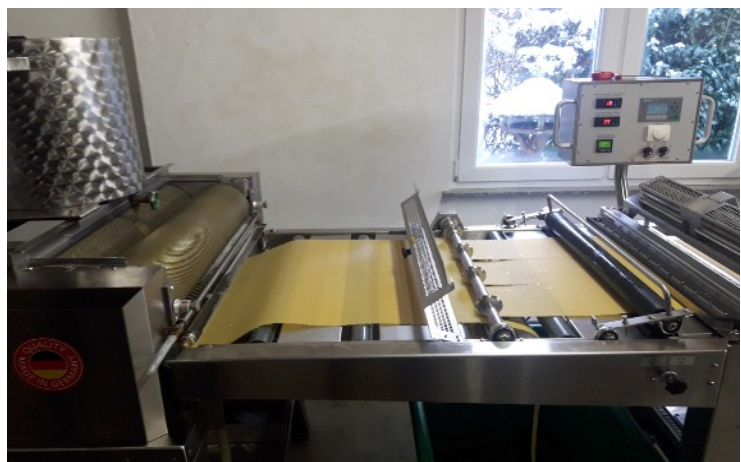
Abb. 3: Mittelwandgießanlage der Imkerei Hirten ( https://www.imkerei-hirten.de/imkerei/ ) →
